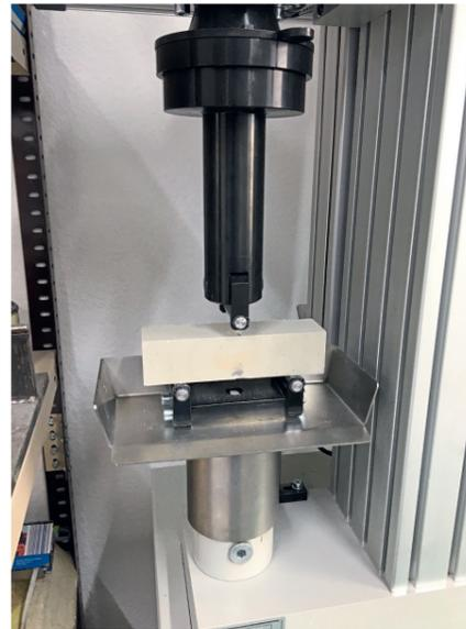
Normprismen (4x4x16 Zentimeter) aus Nivelliermasse im Alter von 28 Tagen nach Normlagerung werden mit der Druck- und Biegeprüfmaschine MEGA 100-200-10 DM 1-S geprüft.
