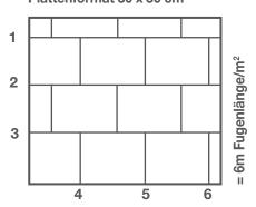
Berechnung der Fugenbreite =  $\frac{600 \text{ cm}^2}{\text{Anzahl Fugen x 100 cm}}$
