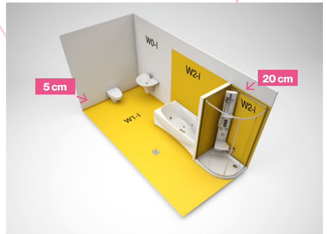
6. Häusliches Bad mit Badewanne und Dusche mit wirksamen Spritzwasserschutz und nicht planmäßig genutztem Bodenablauf im Raum Abdichtungsbauart 1/2
